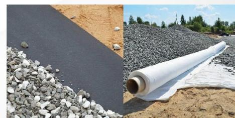
Геотекстиль – прочный синтетический материал, получаемый путем скрепления волокон или нитей механическим (плетение, иглопробивание), химическим (склеивание), термическим (сплавление) способом или их комбинацией.
